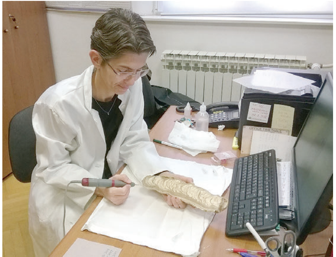
Odvajanje uzoraka sige iz spilje Lokvarke za datiranje metodom U-Th
