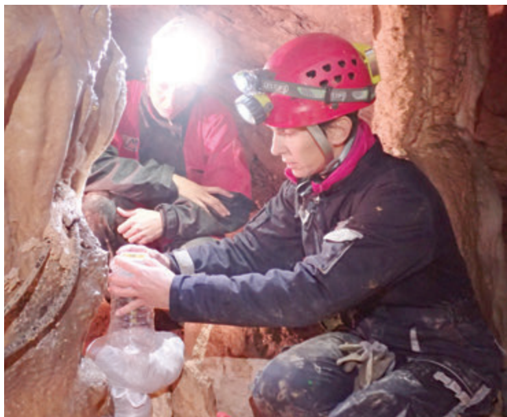
Postavljanje opreme za prikupljanje uzoraka vode prokapske i snimanje intenziteta prokapsavanja u spilji Lokvarci (M. Surić i N. Lončar)
